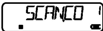
Сканирование радиозэфира на наличие несущей. В частотном режиме сканирует частоту, в соответствии с заданным в меню шагом (STP), в канальном и частотно-канальном режиме сканирует ячейки памяти. Во время сканирования можно изменить его направление стрелками.
